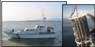
B.O. José Rioja equipado con roseta oceanográfica de 12 botellas.
